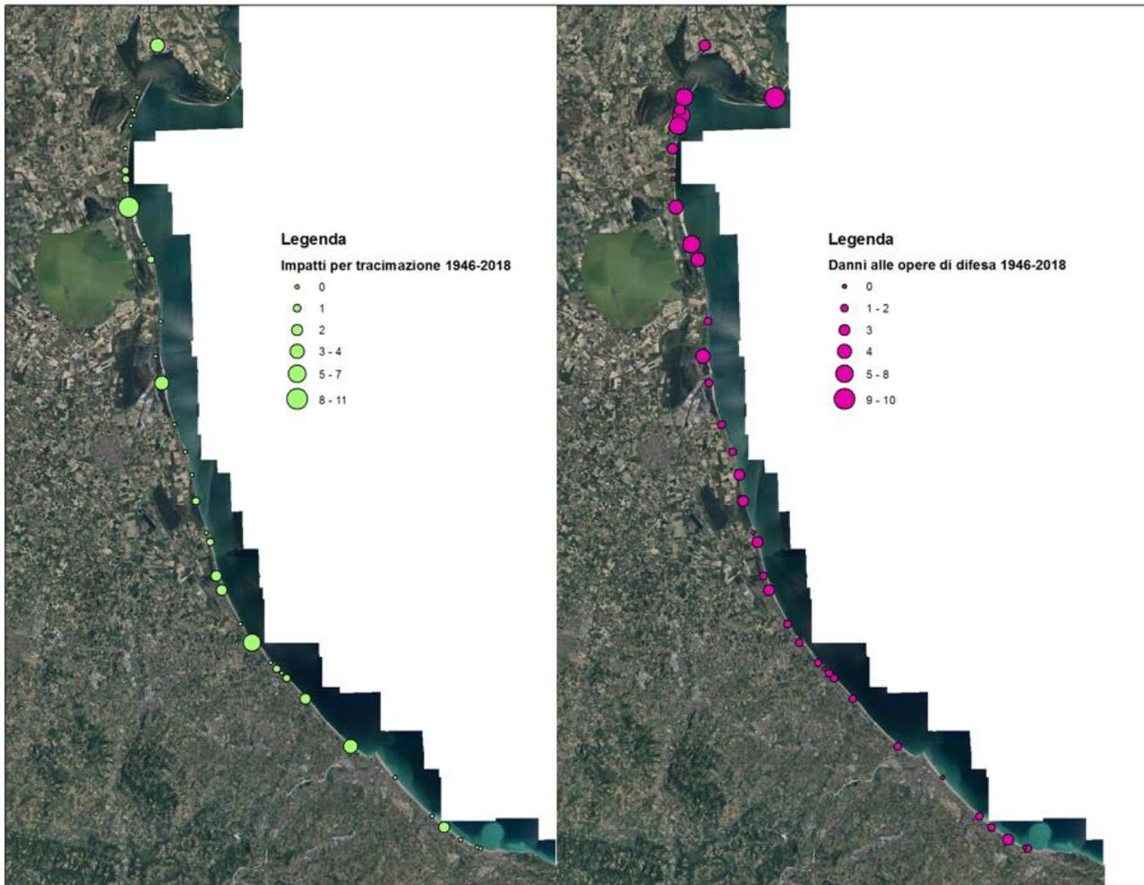
Fig. 18 Distribuzione delle località colpite per tracimazione e danneggiamento delle opere di difesa e numero di eventi
